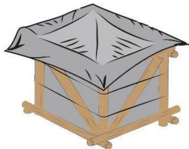
Figura 51. Esquema de tanque de agua en madera (Kawsay, 2020)
